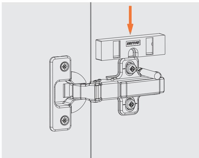
3 – зафиксируйте адаптер крепежным винтом ответной планки
