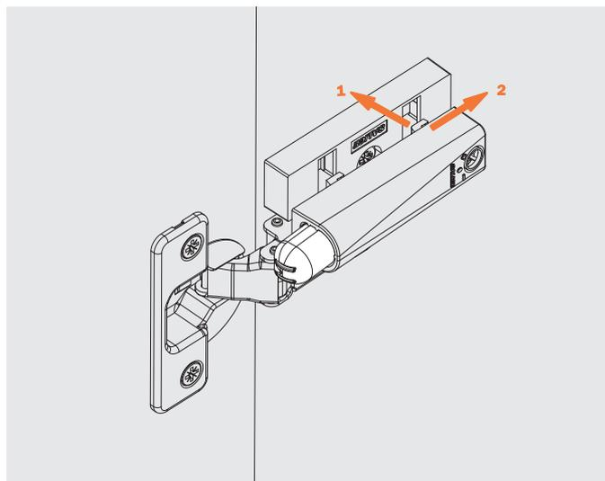
5 – отрегулируйте усилие SMOVEHOLDER регулировочным винтом
