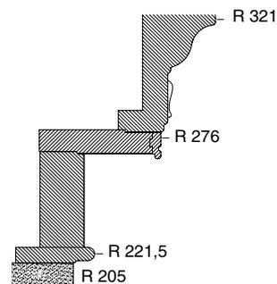
схема крепления закругленных элементов системы карнизов
