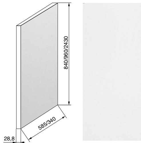
боковина шпонированная толщиной 28,8 мм
