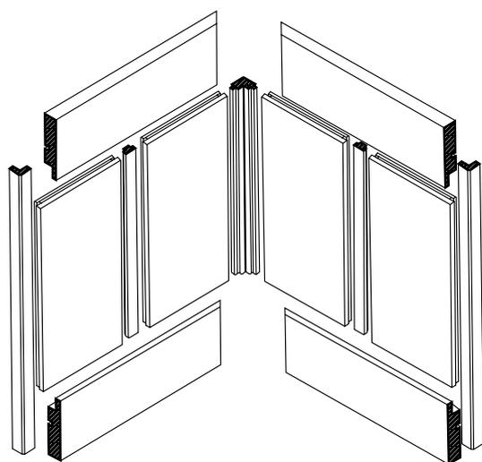
схема крепления Буазери — системы декоративных стеновых шпонируемых панелей
