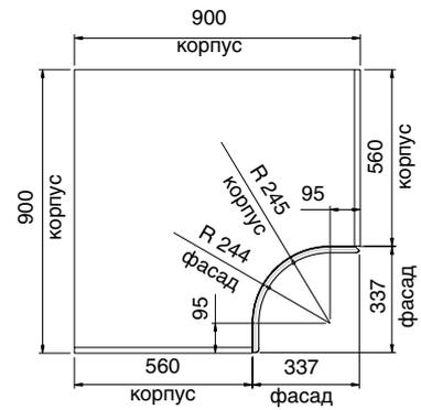
фасад закругленный внутренний для нижних баз
