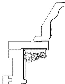
схема крепления прямых элементов системы карнизов
