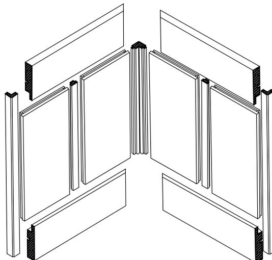
схема крепления Буазери — системы декоративных стеновых шпонированных панелей
