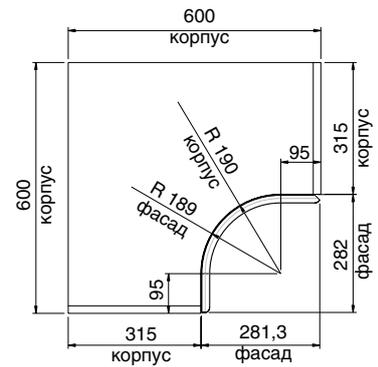
фасад закругленный внутренний для верхних шкафов
