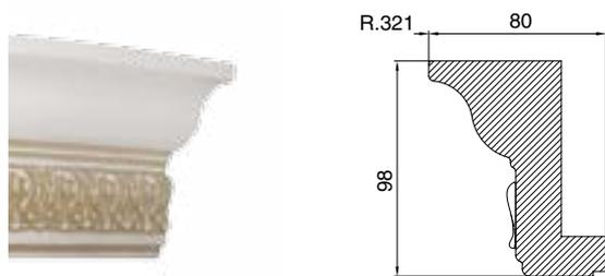
карниз верхний закругленный (для выносной плиты)
